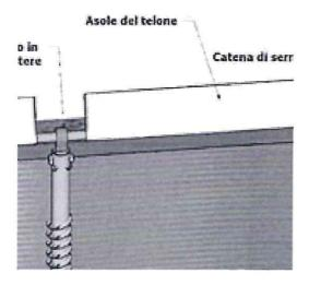
L'ostacolo cui si fa riferimento nell'interrogazione è un tubo di ancoraggio con picchetto a catena che passa all'interno di un'asola, necessario per ancorare la struttura al suolo.
